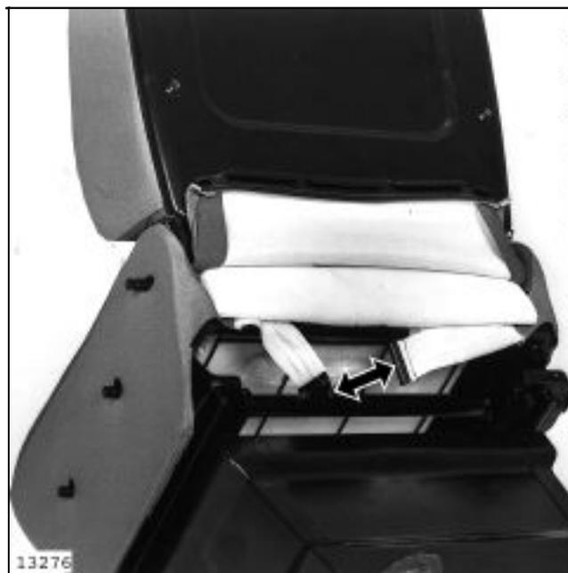
Au centre du siège, soulever la mousse d'assise et déclipser les deux sangles de maintien des côtés de la garniture.
