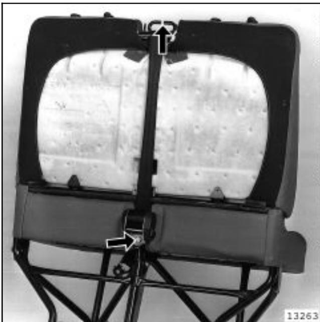
Déposer la vis de fixation de l'enrouleur sur le bâti de siège.
