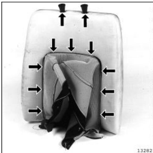
Dégager les embases des guides repose-tête clip-sées sur l'armature.
