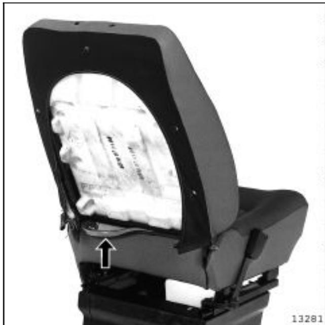
Retirer, à l'aide d'un tournevis plat et d'une pince plate, la bande plastique de retenue de la garniture.
