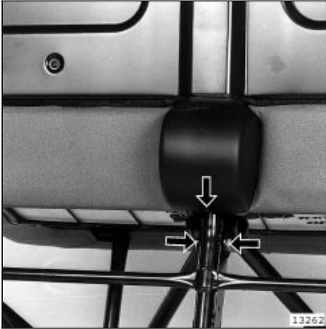
Déposer le cache-enrouleur de ceinture (une vis de fixation).
