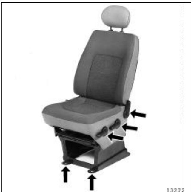
Oter les cache des trois poignées de réglage du siège puis les déposer.
